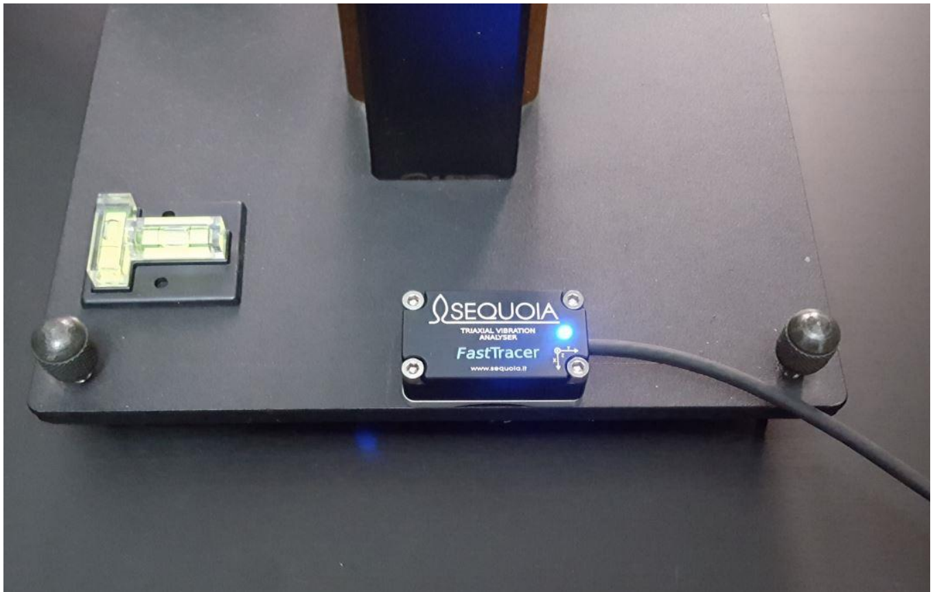
Accelerometro posizionato su base stand Sonus Faber
