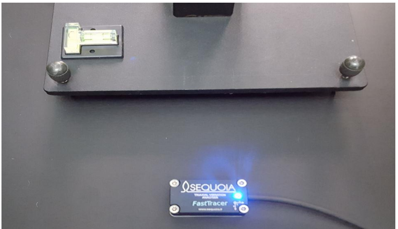
Accelerometro posizionato su base Extrema Voice FCS
