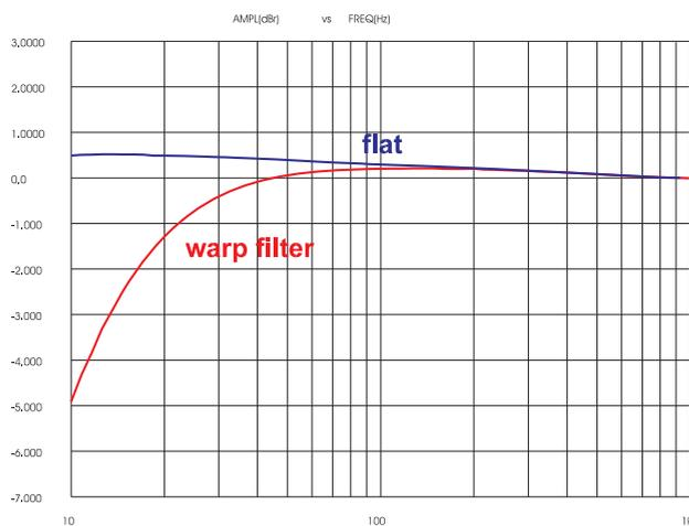
Il filtro antiwarp è ben dimensionato ed inizia ad agire consistentemente solo sotto i 10 Hz, mentre a 30 Hz attenua meno di 1 dB.
